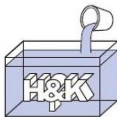
② シリコン注入
