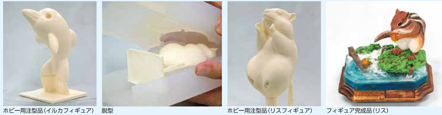
ホビー用注型品(イルカフィギュア) 脱型 ホビー用注型品(リスフィギュア) フィギュア完成品(リス)
